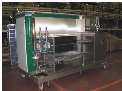
GROUPE DE FROID POUR ALCOOL ET PARFUM AVEC ECHANGEUR A PLAQUE, RECUPERATEUR ET FILTRATION
