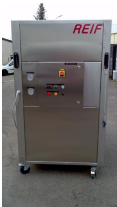
GROUPE DE FROID POUR ALCOOL ET PARFUM AVEC ECHANGEUR A PLAQUE, RECUPERATEUR ET FILTRATION
