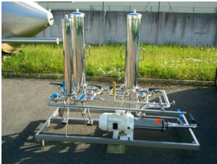
Palette de filtration mixte 5000l/heure Préfiltration lenticulaire 5 \mu 2eme préfiltration cartouche 1,2 \mu Filtration finale 0,45 \mu
