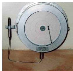
Enregistreur Baladeur thermographe mobile pour le contrôle des températures du cycle.
