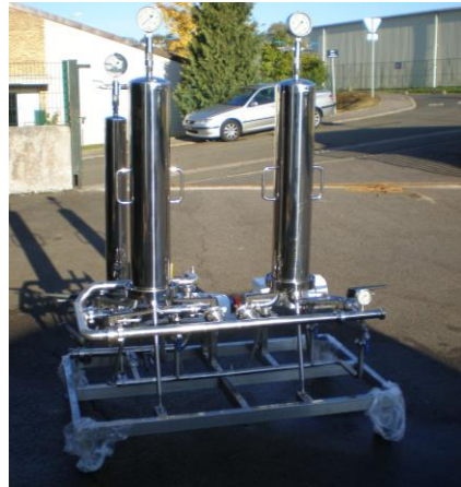
Palette de filtration mixte 5000l/heure Préfiltration lenticulaire 5 \mu 2eme préfiltration cartouche 1,2 \mu Filtration finale 0,45 \mu
