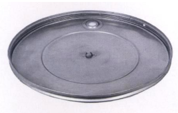
Chapeau flottant inox AISI 304 ou 316 Epaisseur 8/10 mm
