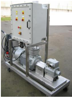
POMPE A PISTON SUIVANT NORME ATEX II 2G c IIB T4 DIRECTIVES UE 94/9/CE
