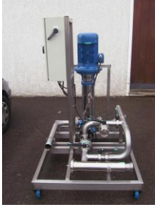
POMPE A PISTON SUIVANT NORME ATEX II 2G c IIB T4 DIRECTIVES UE 94/9/CE
