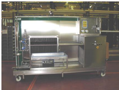
GROUPE DE FROID POUR ALCOOL ET PARFUM AVEC ECHANGEUR A PLAQUE, RECUPERATEUR ET FILTRATION
