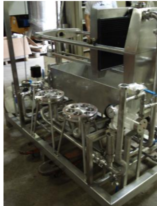
Station de filtration mixte : Filtre à plaques et filtre à membrane
