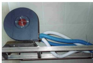
N.1 ventilateur avec un moteur électrique pour l'égouttage des bouteilles. Collecteurs de distribution d'air d'égouttage en acier inox AISI 304 positionné à la sortie du tunnel sur le tapis.
