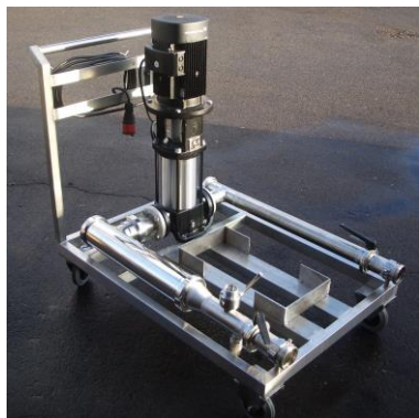
CHARIOT DE LAVAGE AVEC POMPE CENTRIFUGE
