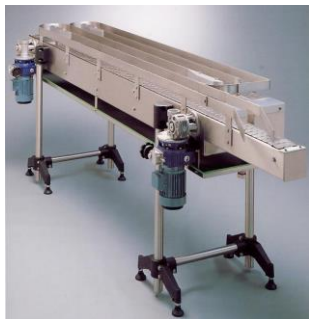
Poumon de décompression, « va et vient » avec variateur de vitesse.
