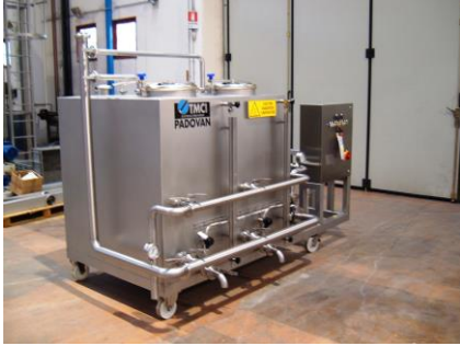
Station CIP 2 cuves avec chauffage
