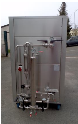
GROUPE DE FROID POUR ALCOOL ET PARFUM AVEC ECHANGEUR A PLAQUE, RECUPERATEUR ET FILTRATION
