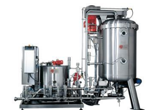
FILTRE A PRESSION VICTORIA AVEC ADJUVANTS DE FILTRATION DE 5 A 15 M2
