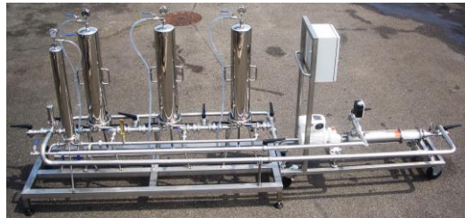
PALETTE DE FILTRATION AVEC POMPE MOBILE
