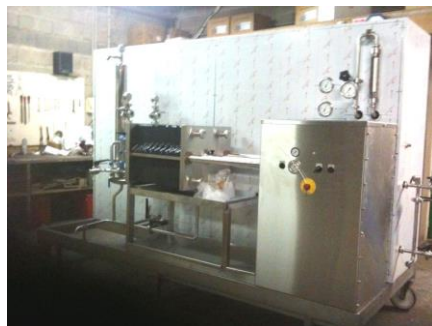
GROUPE DE FROID POUR ALCOOL, -8 -10°C AVEC FILTRE A PLAQUE 40X40 ETANCHE
